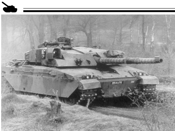
Рис. 2. Английский ОБТ «Челленджер-1», оснащенный прицелом командира с тепловизионной камерой (размещен на башне справа)
